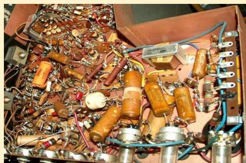
מעגלים אלקטרוניים מלפני כ-90 שנה, רכיבים מחוברים זה לזה באמצעות תגי הלחמה
