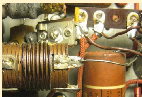
מעגלים אלקטרוניים מלפני כ-90 שנה, רכיבים מחוברים זה לזה באמצעות תגי הלחמה
