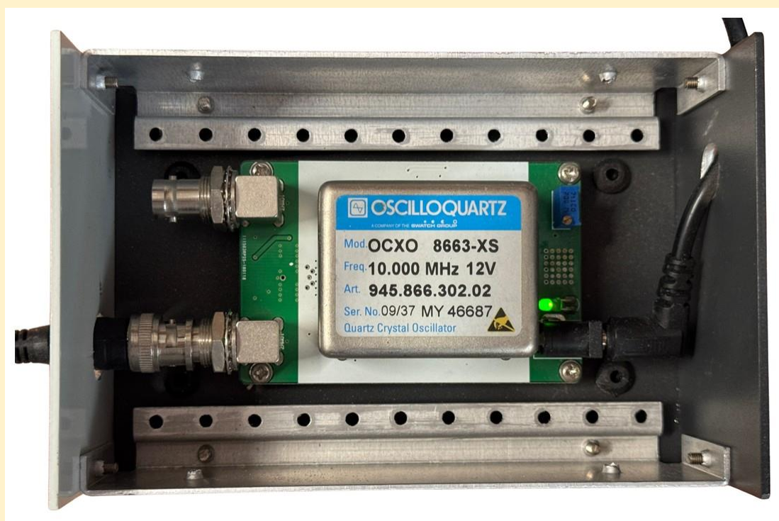
תמונה מס' 1: מתנד OCXO המשמש כתדר ייחוס בתחנת החובבים שלי הנגד המשתנה לכיוון מדויק של התדר – מימין, מעל ה־LED הירוק
