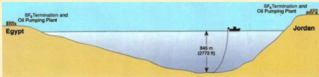
איור 3, הנחת הכבל התת ימי טאבה-עקבה (מתוך Transmission & Distribution World 2/97)
