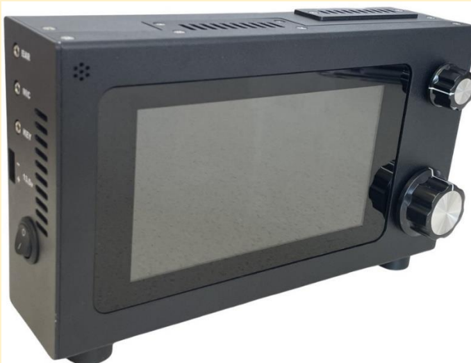
sBitx V3 – קופסא עם חיבורים משני הצדדים, מסך מגע 7 אינטש ושני מקודדים מפזר החום של דרגת ההספק מותקן בגב המקמ"ש.
