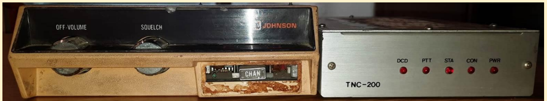
ציוד הפקט רדיו VHFJohnson PPL 6000 25W ש"מקמ"ש (שנות ה-90) (TAPR) 200-TNC
