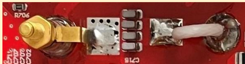
איור מס' 7: דיודת PIN דגם MA4PK3001 תוצרת MACOM, מותקנת במגבר הספק RF2K-S תוצרת RF-KIT
