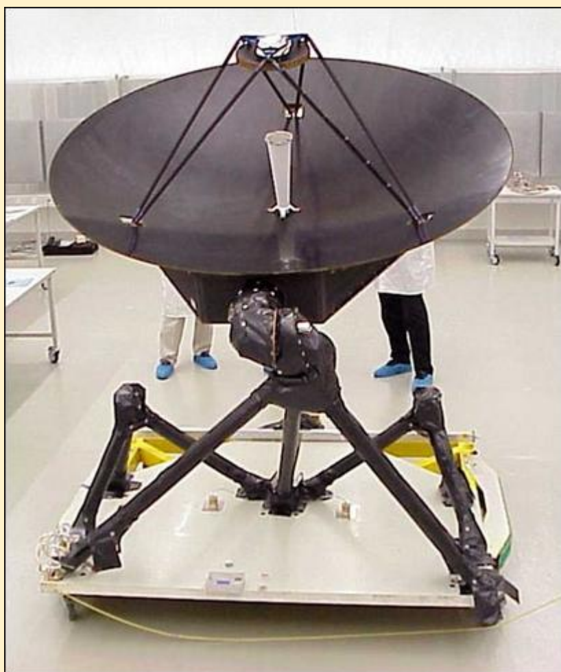
אנטנת התקשורת של הרוזטה קוטר האנטנה 2.4 מטר והיא פועלת כמשדר בתחום תדרי X הספק השידור 24 Watt וקצב השידור מגיע עד 28 kbps (התמונה לקוחה מאתר ESA)
