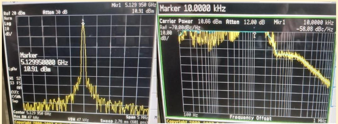
מקור תדר 5,130 מגהרץ עם מתנד גבישי של Phase Noise ומדידות של המקור.
